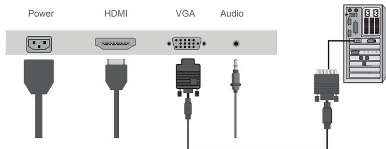
collegare il cavo di alimentazione del monitor alla porta AC IN sul retro del monitor.
